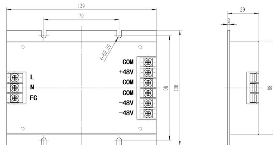
图2 电源外形尺寸图(单位: mm)
