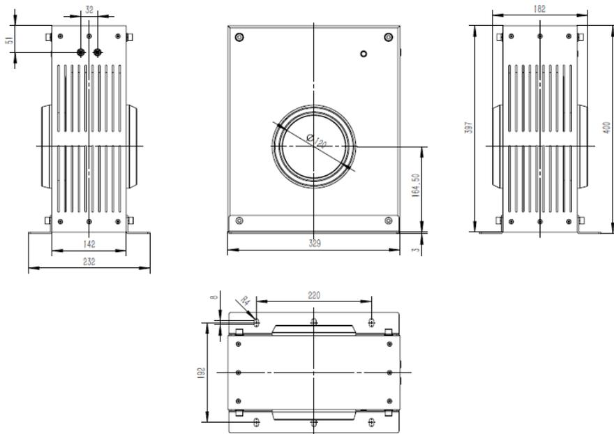
图1 产品外形尺寸(单位: mm)
