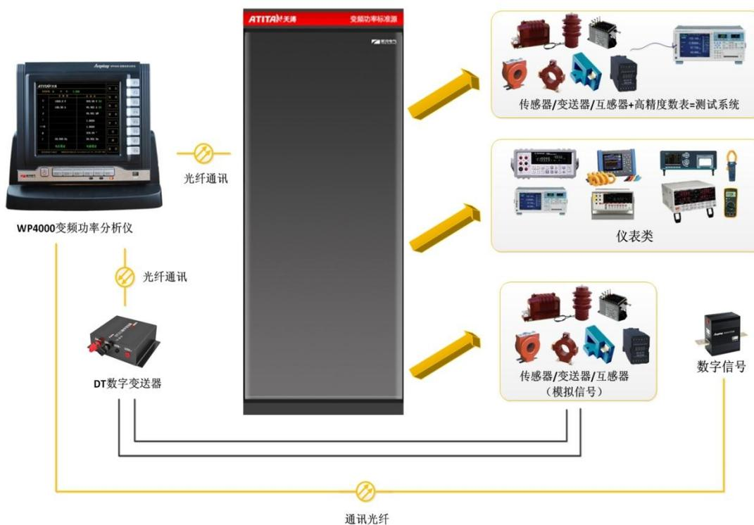
图 2、ATITAN 天涛变频功率标准源构成的变频电量量值溯源系统
