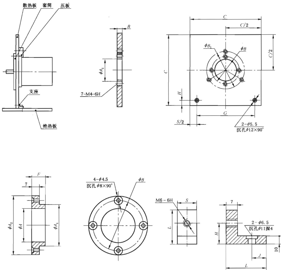
散热板、套筒、支座材料：铝合金，表面阳极氧化处理呈黑色。
