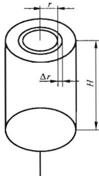
图 C.1 圆柱体转动惯量求解示意图
