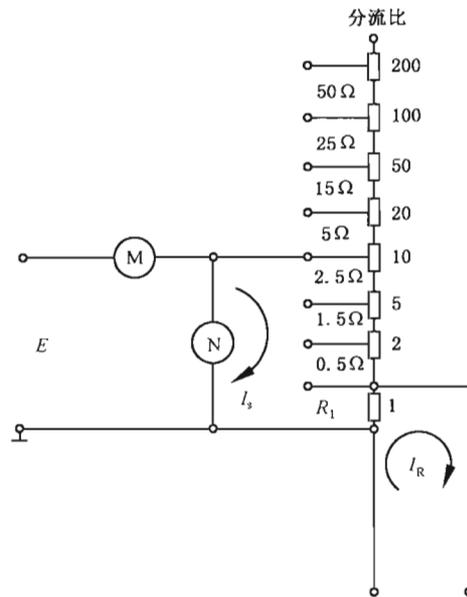
指零仪指零时:  $I_s(R_1 + 0.5 + 1.5 + \dots + R_n) - I_R R_1 = 0$
